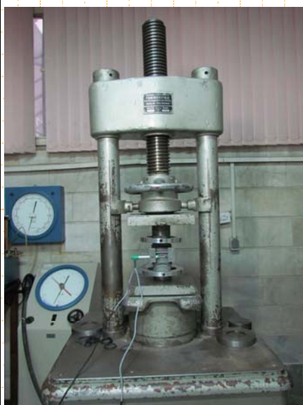
آزمایش تک محوری سنگ
