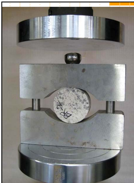
آزمایش مقاومت کششی سنگ (آزمایش برزیلی)
