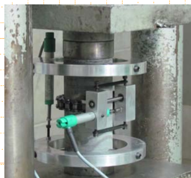
آزمایش مدول الاستیک و ضریب پواسن سنگ
