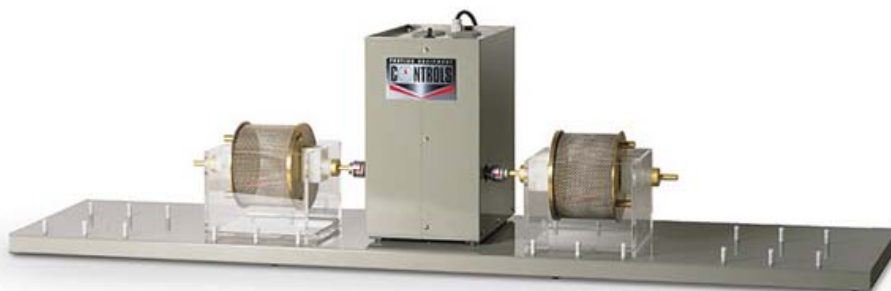
آزمایش دوام سنگ در مقابل آب دیدگی
