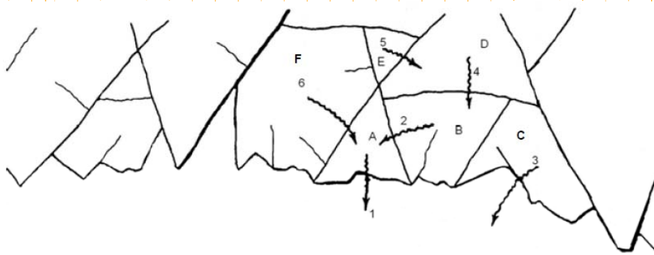
نحوه انتشار گسیختگی بلوکی در توده سنگ های ناپیوسته
