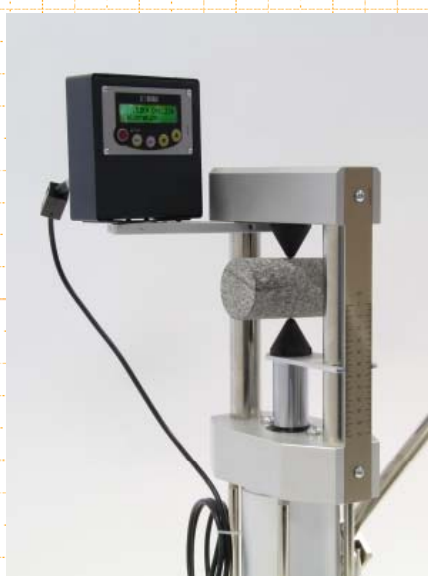
آزمایش بار نقطه ای سنگ
