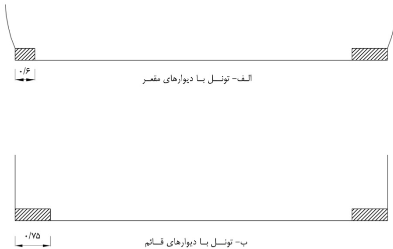
شکل ۶-۲۲- عرض پیاده‌روها با دیوارهای مختلف تونل
