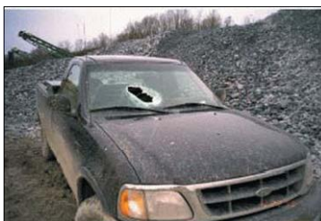
شکل (۱): تلفات انسانی ناشی از پرتاب سنگ در معدن سنگ آهک ایالت پنسیلوانیای آمریکا [۳]
