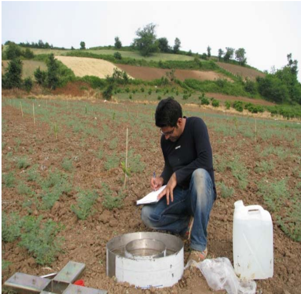
شکل ۲: آزمایش نفوذپذیری خاک به روش استوانه مضاعف در نقاط شماره ۳ (شکل الف) و ۱۳ (شکل ب)
