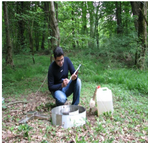
شکل ۲: آزمایش نفوذپذیری خاک به روش استوانه مضاعف در نقاط شماره ۳ (شکل الف) و ۱۳ (شکل ب)
