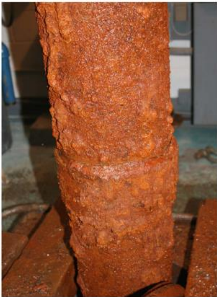
ایجاد رسوب روی لوله مکش پمپ آب از چاه
