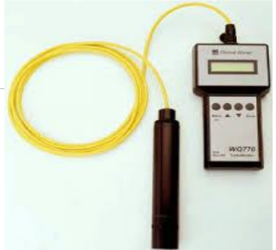
كدورت سنج الكتريكي مجهز به حسگر
