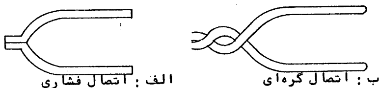
شکل ۷ - اتصالات سیم های ترموکوپل
