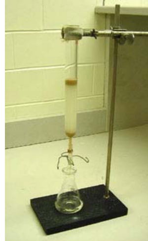
شکل ۱۸: انواع ستون کروماتوگرافی و نحوه‌ی نصب آن
