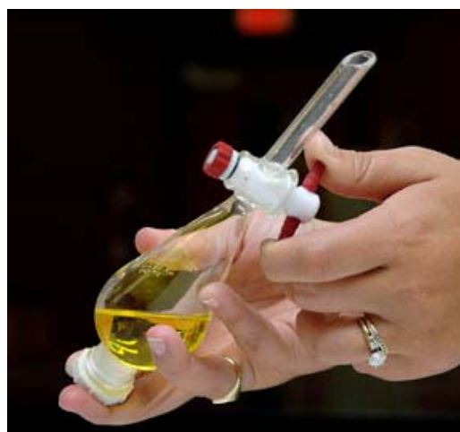
شکل ۱۱: روش کار با قیف جداکننده (دکانتور)
