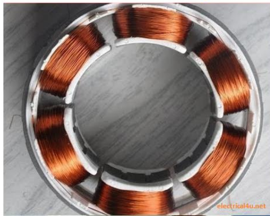
(د) استاتور یک موتور BLDC واقعی (دارای سیم پیچی استاتور متمرکز)
