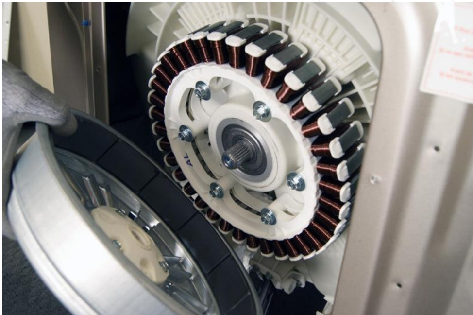
موتور براشلس ماشین لباسشویی با اتصال Direct (بدون تسمه) یا موتور براشلس روتور خارجی
