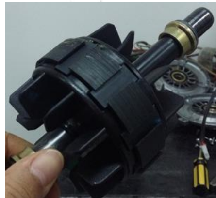
(ب) ساختار یک موتور آهنربای دائم بدون جاروبک سه فاز
