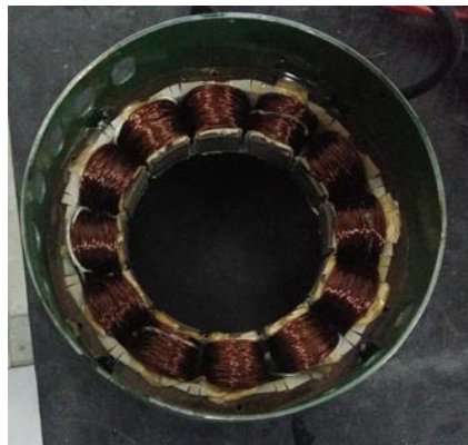
(ب) ساختار یک موتور آهنربای دائم بدون جاروبک سه فاز
