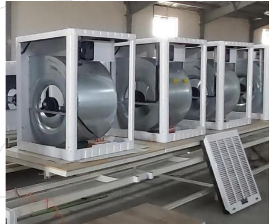
(الف) کولرهای آبی کم مصرف با موتورهای برانشلس
