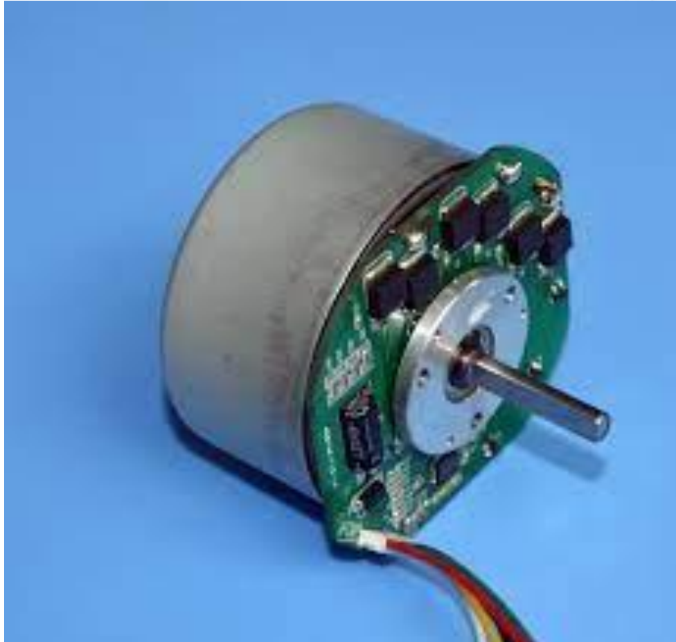
درایو موتور BLDC با ابعاد کوچک نصب شده بر
