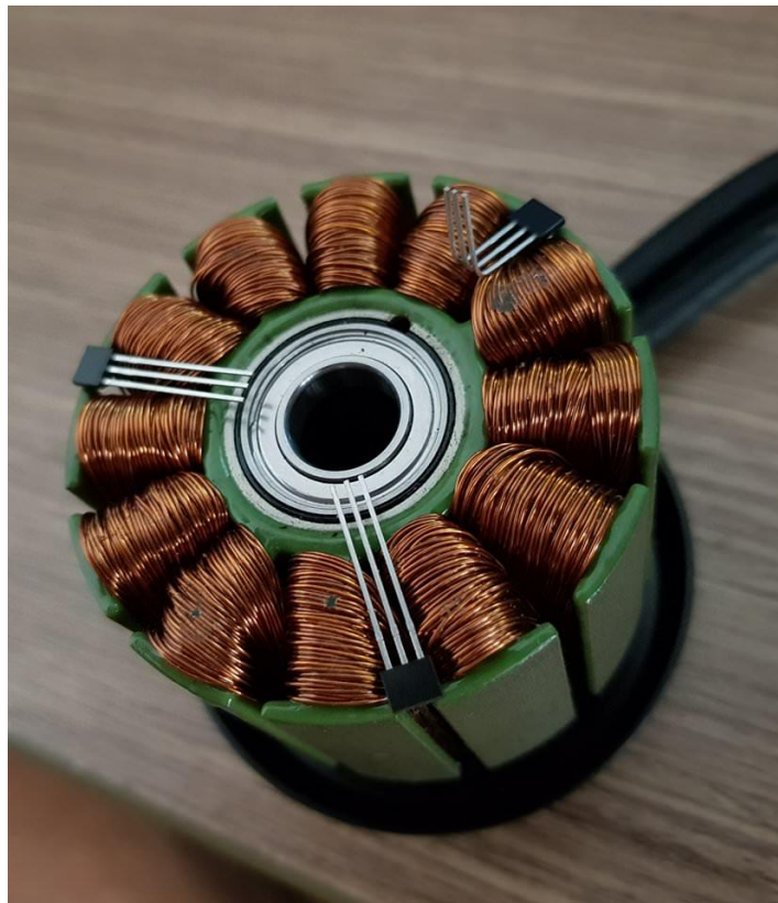
سه حسگر موقعیت اثر هال در موتور BLDC نوع روتور خارجی
