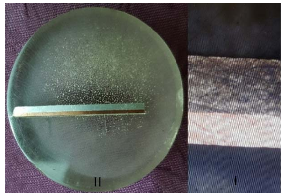
شکل ۷) قراردادن و پرداخت کاری مقطع ورق دوفلزی آلومینیوم- مس و تصویر VMM گرفته‌شده از نمونه
