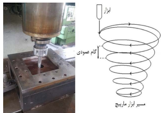
شکل ۸) تجهیزات فرم‌دهی ورق سوختار و شماتیک مسیر ابزار
