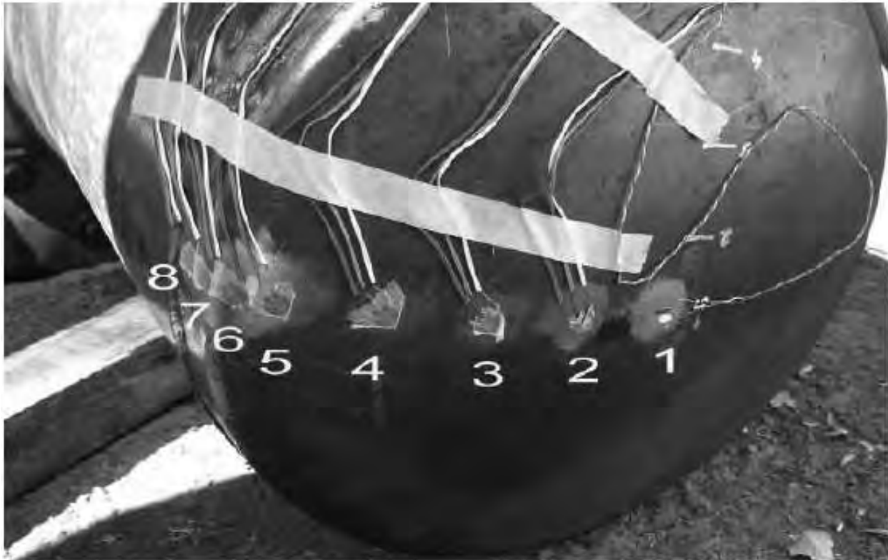
شکل ۱۳: مدل ساخته شده به همراه چیدمان استرین گیجها [۱۲]
