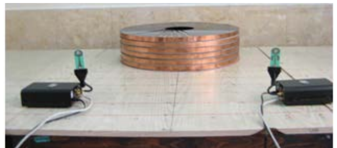
شکل ۱: نحوه قرارگیری تجهیزات اندازه‌گیری و مدل سیم پیچ و آنتن‌های ویوالدی
