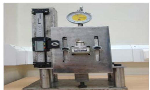
شکل ۴: مدل ساخته شده برای ترانس جهت آزمایش در حوزه فرکانس
