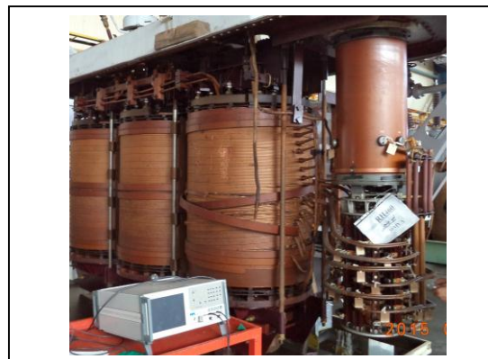
شکل ۸: تست ترانس با استفاده از دستگاه امپدانس آنالایزر
