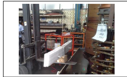
شکل ۱۱: اسکن ترانسفورماتور با دو آنتن فرستنده و گیرنده
