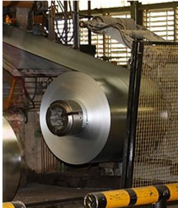
شکل (۱): تبدیل ورق فولادی به کلاف، توسط تنش ریل
