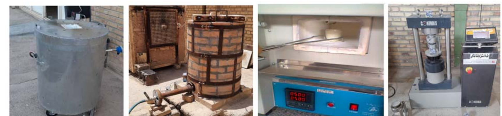
شکل ۲: از راست به چپ: جک ملات شکن، کوره الکتریکی، کوره گازی آجری و کوره گازی پرتابل برای بهینه سازی فرآیند تولید خاکستر
